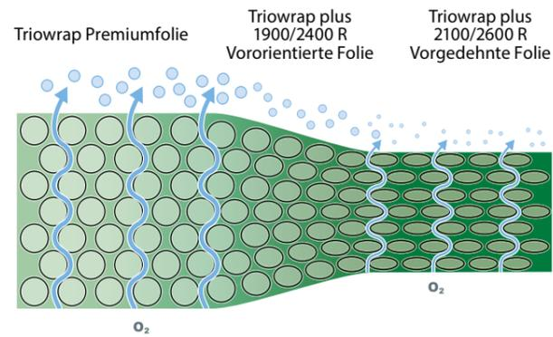
Die spezielle Technologie ermöglicht es, weniger Rohstoffe für die Herstellung einer hochwertigen Wickelfolie zu verwenden. Die LCA-Werte für unsere PlusTech-Folien belegen eine Reduzierung des CO<sub>2</sub>-Fußabdrucks um bis zu 25 %. Außerdem wird durch den geringeren Kunststoffverbrauch pro Ballen der Abfall reduziert. Gleichzeitig können Sie Ihre Effizienz erheblich steigern, da Sie mehr Folienmeter pro Rolle verarbeiten können! Die Grafik unten zeigt Ihnen, um wie viel.
